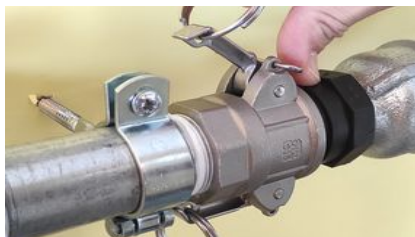
Le spine di sicurezza evitano aperture accidentali
