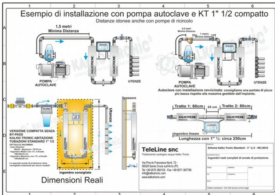
Viene fornita l'apposita idraulica dedicata che può essere montata a forma di "U" o lineare, con elettrodi di trattamento già installati e protetti, del diametro 1"½ per trattare tutto l'appartamento. In caso di ricircoli ACS e spazi limitati l'idraulica può essere di 1" (fornitura solo su richiesta). Le misure indicate a disegno possono avere una tolleranza fino al 5% rispetto alle misure reali.
