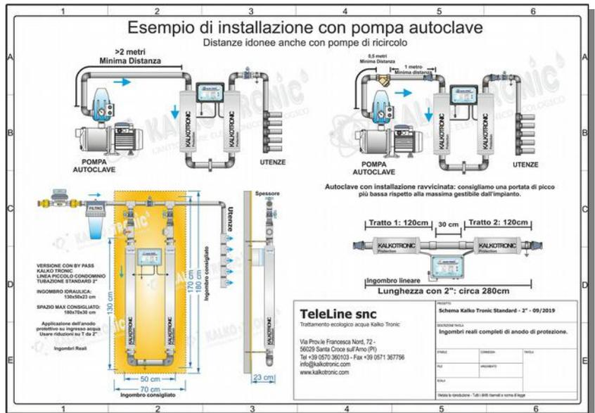
In caso di installazione in impianti con acqua calda centralizzata, l'impianto dovrebbe essere installato in uscita dall'autoclave sull'acqua fredda, secondo le precedenti istruzioni, ma corredato anche di un secondo apparecchio che permetta di mantenere alto il trattamento sull'acqua di ricircolo sanitario (là dove esiste).
