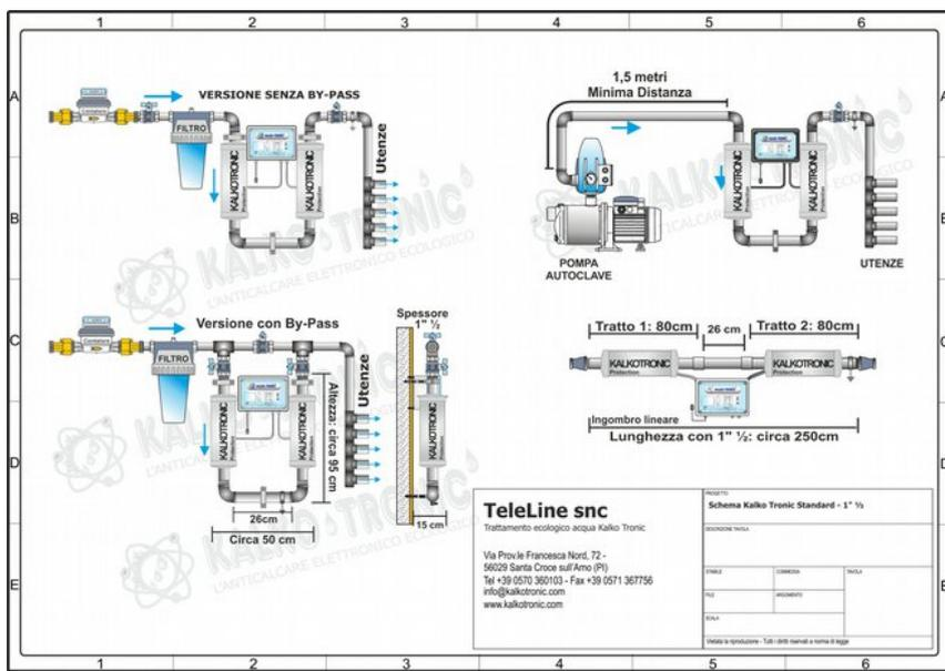
Viene fornita l'apposita idraulica dedicata che può essere montata a forma di "U" o lineare, con elettrodi di trattamento già installati e protetti, del diametro 1"1/2 per trattare tutto l'appartamento. In caso di ricircoli ACS e spazi limitati l'idraulica può essere di 1" (fornitura solo su richiesta).
