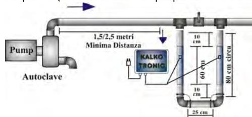
L'impianto deve essere installato dopo l'autoclave (mandata acqua fredda) e sempre ad una distanza variabile tra 1,5 e 2,5 metri dalla pompa di spinta, secondo la portata della stessa (si consiglia di contattare l'ufficio tecnico per delucidazioni o consultare il manuale di progettazione d'impianto).
