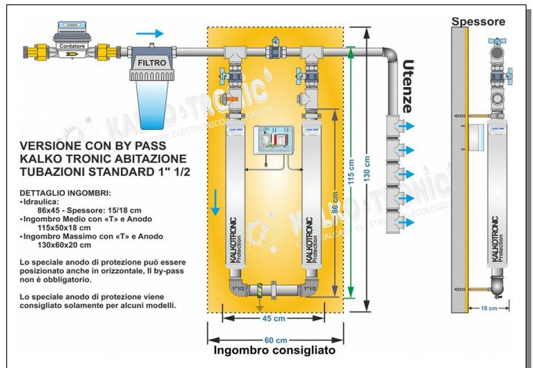
In caso di installazione su un singolo appartamento e/o con durezza inferiori a 45°Francesi il KT Micro Plus Power, rispetto agli apparecchi di gamma più piccoli, esalta al massimo l'efficacia di trattamento riuscendo, talvolta, a dare anche una sensazione di "leggerezza" all'acqua grazie alla maggior incisività che opera sui cristalli di calcare.
