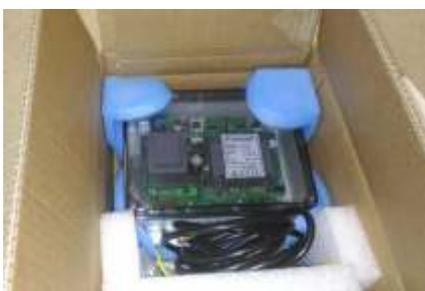
Le elettroniche, con idrauliche da 2" a 4", sono spedite separatamente dall'idraulica per evitare danni durante il trasporto.
